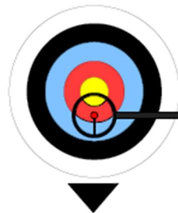
Si le viseur à tendance à baisser, il faut renforcer la puissance de la branche du bas, ce qui se traduit par une augmentation du tiller
