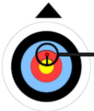
Si le viseur à tendance à monter, il faut renforcer la puissance de la branche du haut, ce qui se traduit par une diminution du tiller
