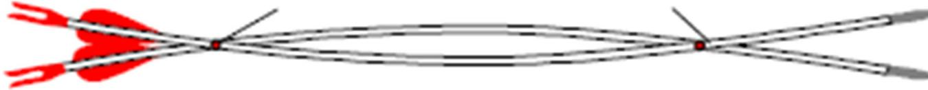
Au repos, la flèche n'exerce aucune pression sur le Berger button et est légèrement décalée (à gauche pour un droitier, à droite pour un gaucher) de l'axe de tir
