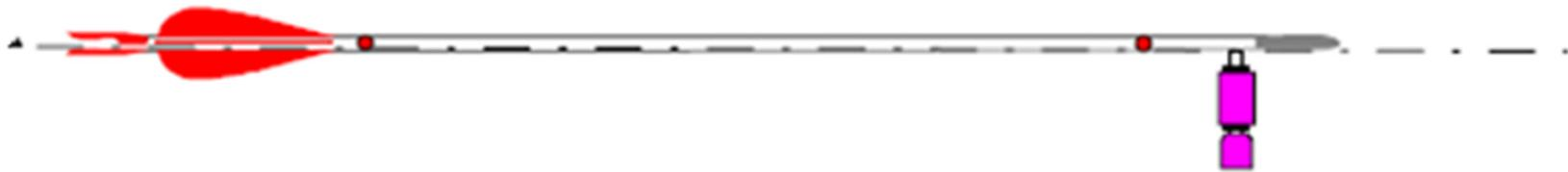
Lors de la décoche, la flèche exerce une pression sur le Berger button, ce qui le fait rentrer un peu et **aligne les nœuds de la flèche dans l'axe du tir**.
